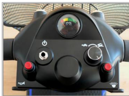
CUADRO DE MANDO Regulador velocidad Luces LED – Claxon Indicador carga batería
