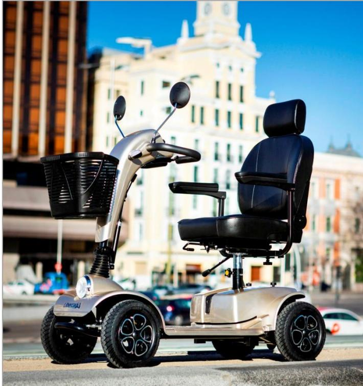
♣ Motor 350W - Baterías 2x32Ah - Velocidad máx. 10km/h
