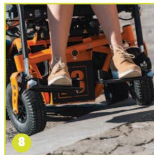
Eje basculante delantero para terrenos irregulares
